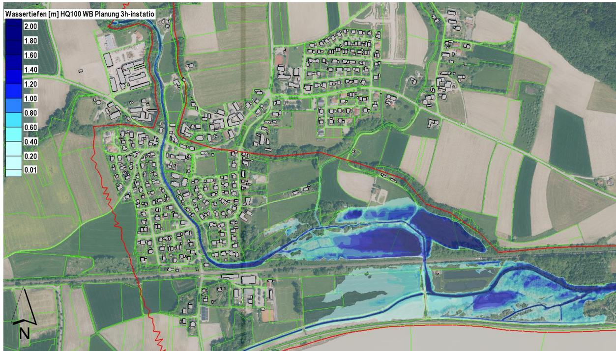
Abbildung 5.4: Abflusssituation Planungszustand, Lastfall maximaler Scheitel HQ<sub>100</sub> WB
