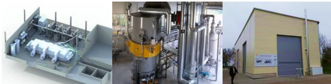
Abbildung 152: Energieautarke und dezentrale Klärschlammverwertungsanlage, zur energetischen und stofflichen Verwertung des getrockneten Klärschlammes; Reformierungsanlage zur thermischen Vergasung; Fa. Thermosystem GmbH
