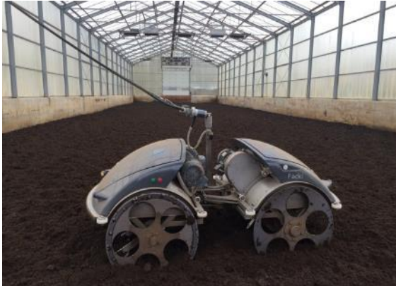
Abbildung 149: Mechanisches Schwein im Vordergrund und Abluftventilatoren an der Hallendecke, Raibling
