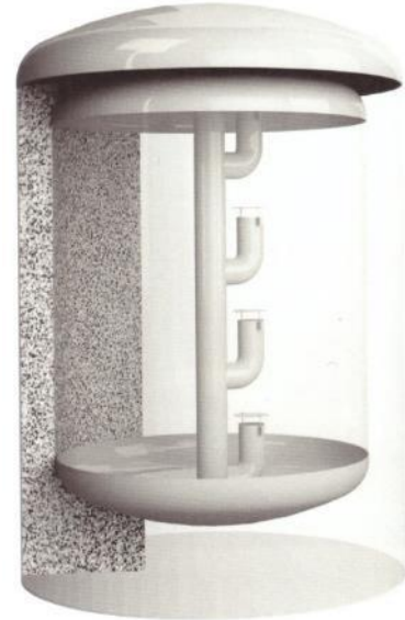
Abbildung 135: Schichtenbeladungssystem und Perlitfüllung des Puffers
