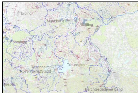
20 kV-Netze und Umspannwerke
